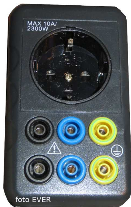
Stopcontact met randaarde met allerlei testmogelijkheden – foto Erik Verbeeck .
