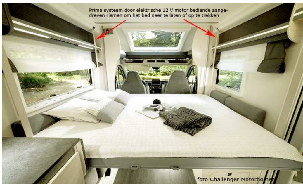
Bed heeft een dubbele functie, het dient als plafond met ingebouwde spotverlichting en kan elektrisch neergelaten worden om te dienen als bedfunctie, een prima systeem dat bij Eric en Heidi te snel faalde.
