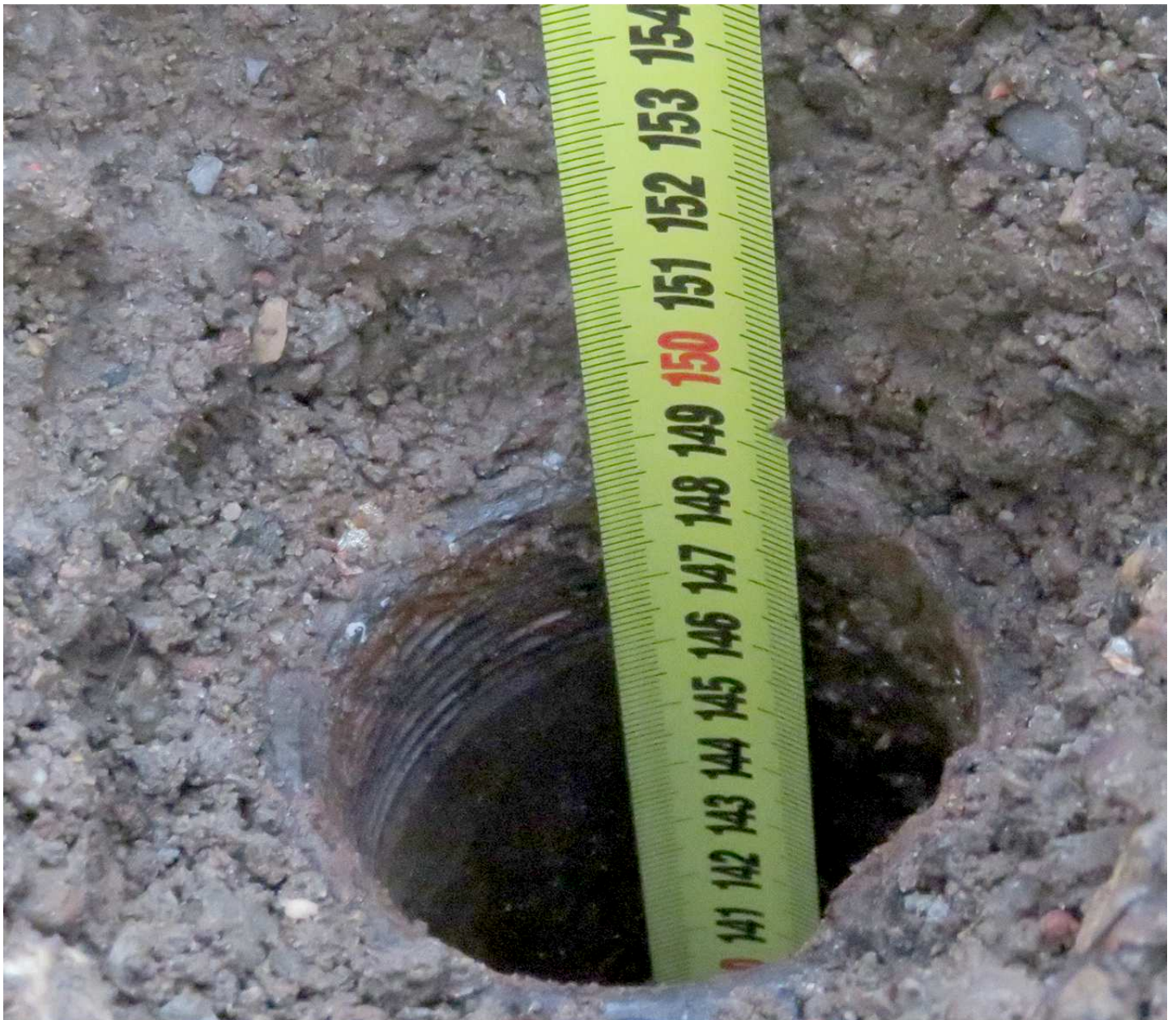
Diepte tot en met de dop 1480 mm - niveau stookolie al dan niet gemengd met water 680 mm
