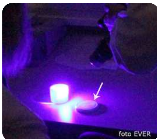
Vingerafdrukken op een wit deksel zichtbaar maken met behulp van ultraviolet licht.
