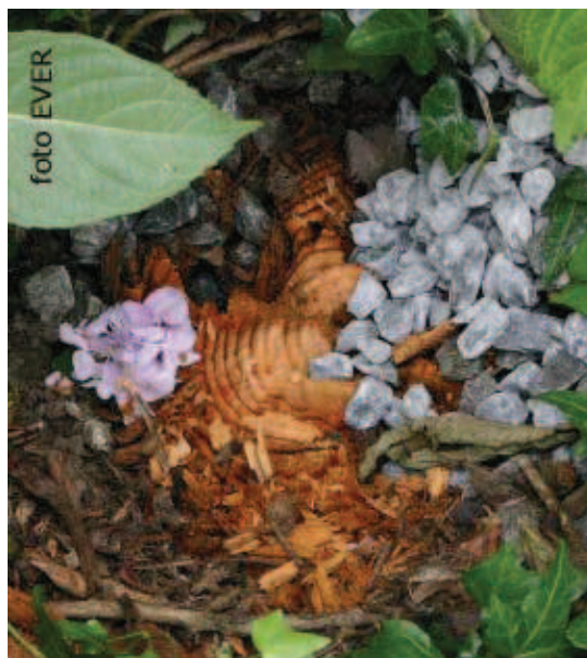
De resten van de totaal door houtworm aange-taste en gelijk met de grond afgebroken paal
