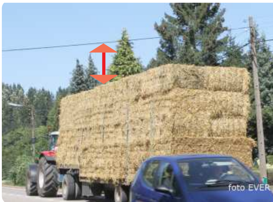
Twee dagen na het ongeval en nadat de overspanning is hersteld. Op het rijvak waar de kabel het hoogst hangt is er voor deze lading nog ruimte. De kabels van televisie en laagspanning werden samengebundeld en ook dat mag niet.
